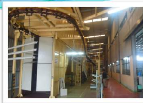
Powder painting Dây chuyền sơn tĩnh điện
