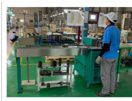
Bus-bar fabrication Gia công thanh cái
